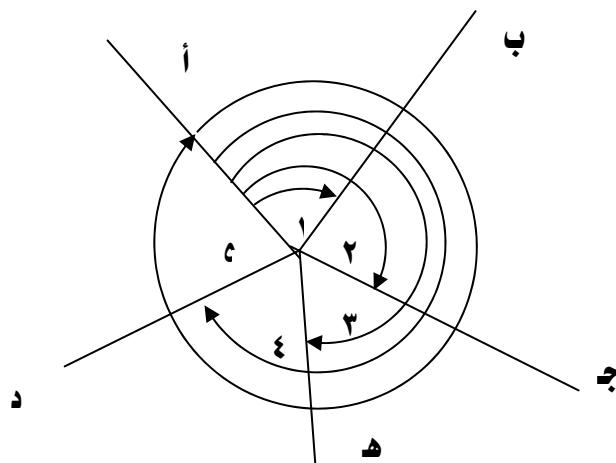
شكل رقم (١١) يوضح طريقة الاتجاهات في قياس الزوايا الأفقية
